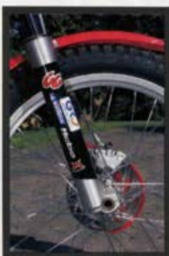
Horquilla Marzocchi con barras de 40 mm de diámetro y ejes de aluminio 7075.
